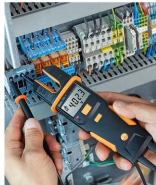
Spannungsmessung an einem Schaltschrank mit **testo 755-2**.
